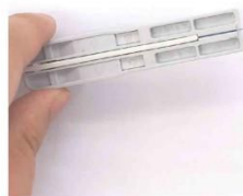
5 打开光纤连接器后盖，将剥好的光纤插入中间导向孔
