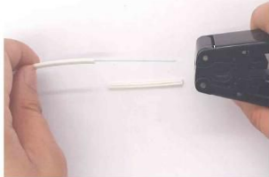
3 无水酒精+无尘纸擦拭裸纤清除涂覆层残留
