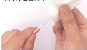
3 无水酒精+无尘纸擦拭裸纤清除涂覆层残留
