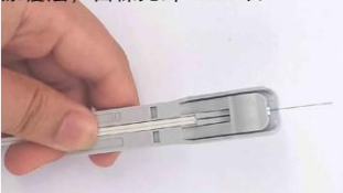
2 使用导轨条剥出 0.25mm 涂覆层，留裸光纤 20mm 长
