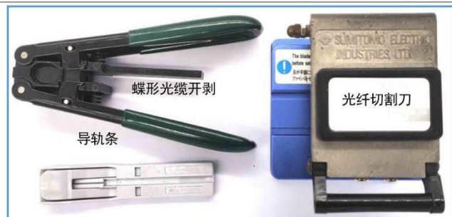
1b 将蝶形光缆开剥 50mm 长
