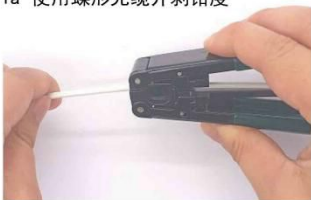
2 使用导轨条剥出 0.25mm 涂覆层，留裸光纤 20mm 长
