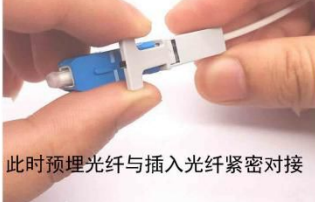
9 取下钥匙，完成对插入光纤锁定
