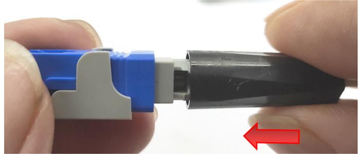
9 取下插片, 光纤被压紧完成连接
