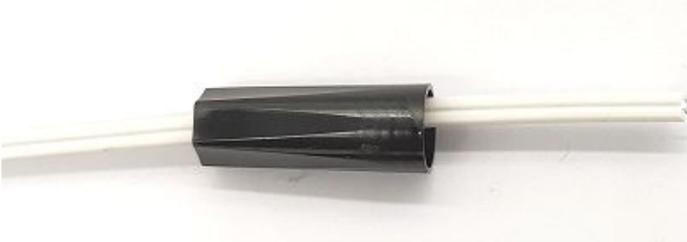
2 用皮线开剥钳剥出 40~50mm 涂覆层
